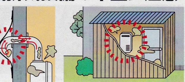
外壁の塗装時に養生シートで給排気設備をふさいだり、屋外式の燃焼器を波板等で囲むと、燃焼器から発生したCOが室内に滞留し、CO中毒の原因になります。
